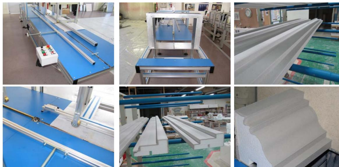
Macchina per spalmatura ad estrusione di malte cementizie e sintetiche
